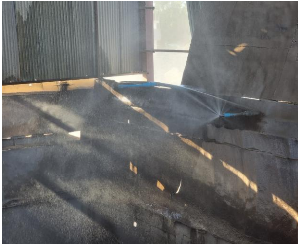
รูปที่ 2-5 (ต่อ) การปิดคลุมสายพานและติดตั้งระบบสเปรย์น้ำ
